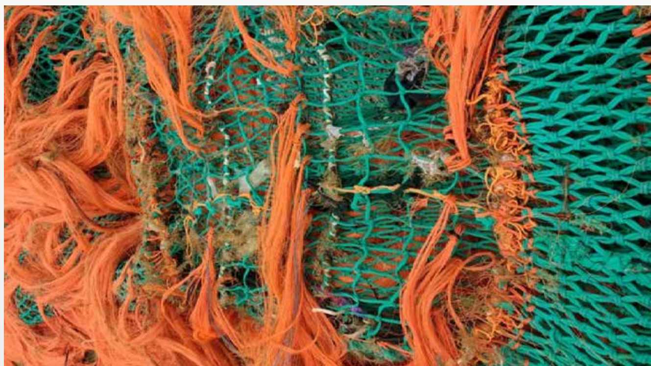
Figuur 1: Een foto van het 200 mm eBRP gebruikt tijdens de laatste testreizen. Het elektrisch veld werd gecreëerd tussen flexibele elektrodes die om de 40 cm (4 vierkante mazen van 10 bij 10 cm) dwars op de sleeprichting werden op het eBRP vastgemaakt. De eerste elektrode zat bij de aanzet van het paneel, het tweede en derde zijn herkenbaar aan het witte touw waarmee ze vastgelegd werden en de laatste zat bij aan het einde van het paneel. De nieuwe, flexibele elektroden die hier gebruikt werden hadden als voordeel dat ze bij het binnenhalen van de vangst samen met het net konden opgerold worden.
