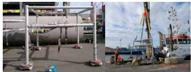
Figuur 2 - Links: Frame met meetinstrumenten (LxBxH: 2 m x 2 m x 1,8 m - gewicht: 1 ton). Rechts: Aan boord brengen van het frame op Meetschip Zeetijger voor het plaatsen op de meetsecties 100-101 en 104 te Mariakerke.
