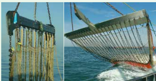
Afbeeldingen 2 en 3: pulstuigen in verschillende ontwerpen
