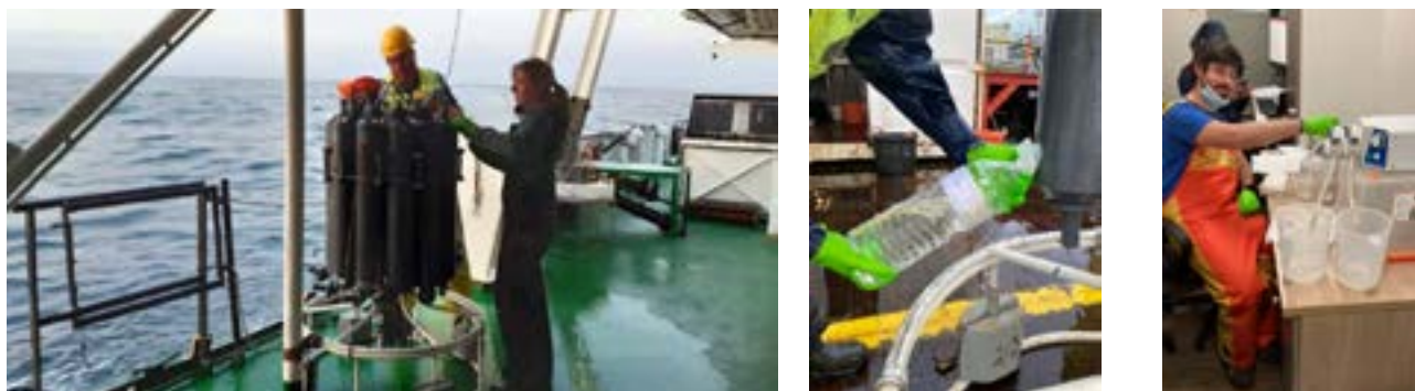
Figuur 2: Verzamelen van waterstalen met Niskin carousel (links). Opvangen van het water voor bewaring (midden). Filteren van het water om het eDNA te isoleren (rechts).
