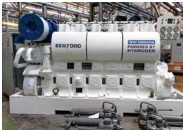
Afbeelding: Een voor 100% op waterstof draaiende BeHydro monofuel motor ontworpen in 2022 door ABC
