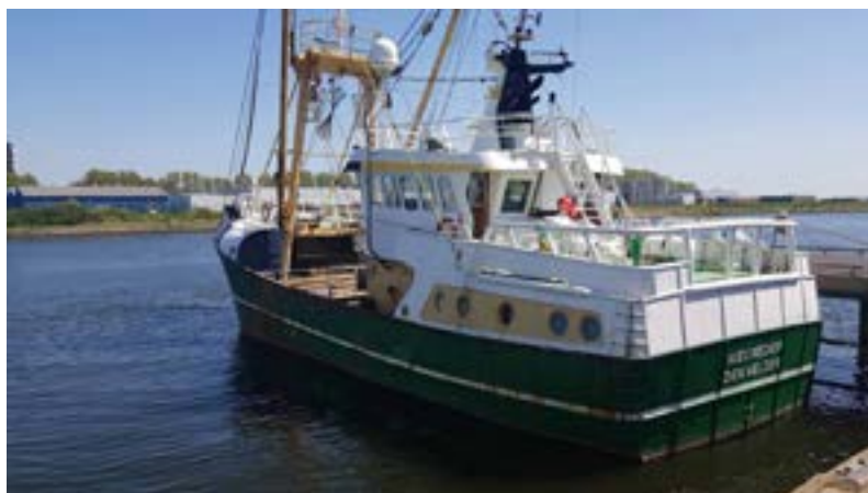
Figuur 1: De voor krabbenvisserij omgebouwde kotter (HD3).
