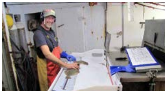
Foto 1: ILVO zeegaande waarnemer met digitale meetplank om accuraat de lengte van een vis te meten. De gegevens worden direct doorgestuurd naar een toughbook waar alle data automatisch opgeslagen worden en bij terugkomst van een zeereis rechtsreeks in de ILVO-database gedownload worden. Vooraleer de gegevens gebruikt worden, ondergaan deze een aantal kwaliteitscontroles (foto: ILVO).
