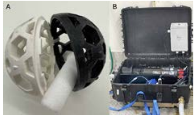
Figuur 1. A) metaprobe, een holle 3D-geprinte bol met daarin steriel gaas dat eDNA absorbeert uit het zeewater in het net; B) automatische eDNA sensor uit het BAR eCollect project dat 14 eDNA stalen kan inzamelen.
