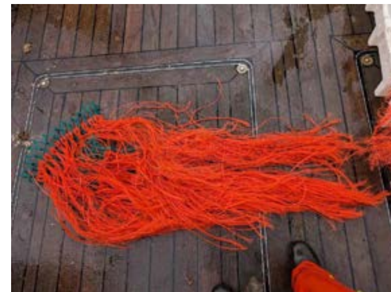
Referentiepaneel met traditionele spekking voor vergelijking met bio-gebaseerde materialen tijdens proeven op zee.
